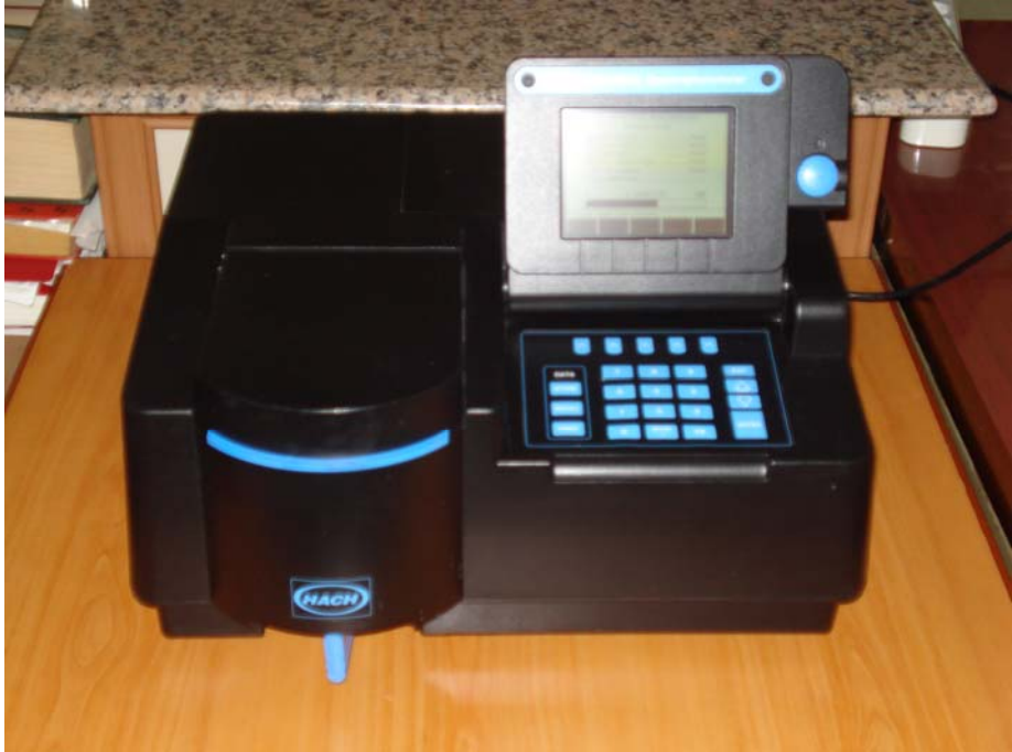
Şekil 3.7. Hach Model DR-4000 Spektrofotometre
