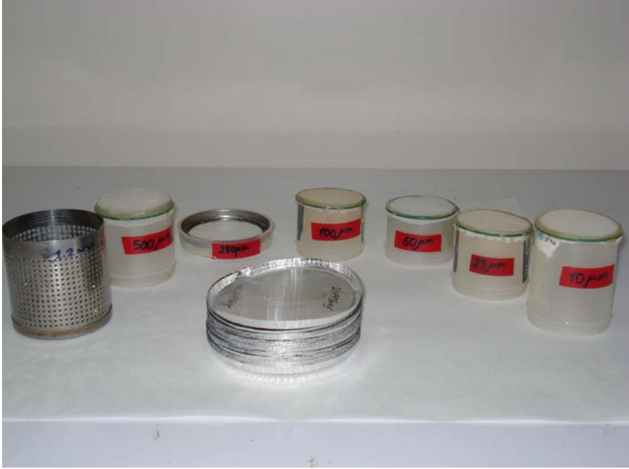
Şekil 3.5. Islak Elek Analizi Elek Sistemi
