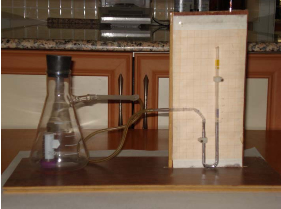
Şekil 3.4. Manometrik yöntemle sedimentte inorganik karbon tayini sistemi
