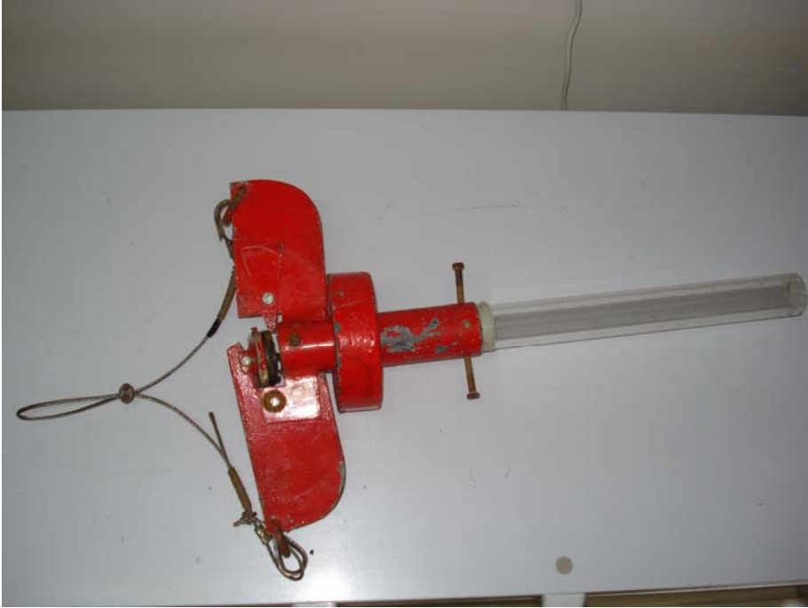
Şekil 3.3. 4,7 cm çaplı (ID)Yerçekimsel Karot Örnekleyici (Gravity Corer)
