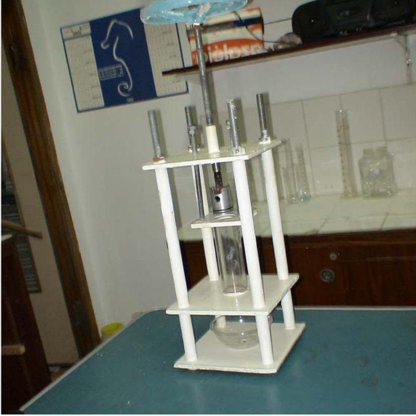
Şekil 7. Pore Water Squeezer (Sediment Ara Suyu Çıkarıcı).
