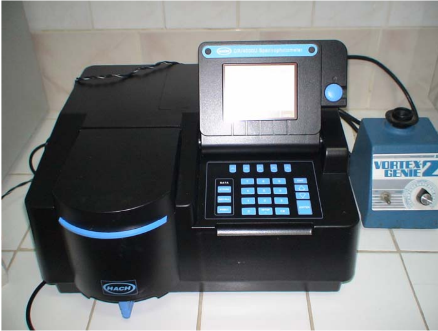
Şekil 8. Nutrient Analizlerinde Kullanılan Hach model DR-4000 spektrofotometre.
