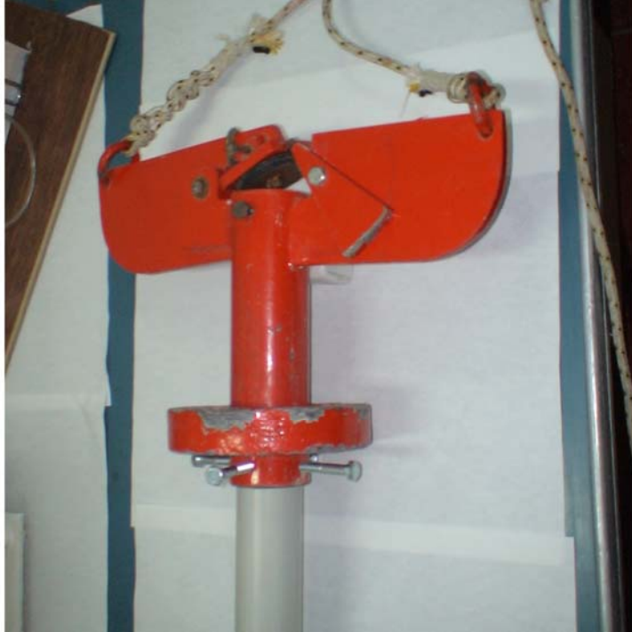
Şekil 4. 4,7 cm çaplı (ID)Yerçekimsel Karot Örnekleyici (Gravity Corer).
