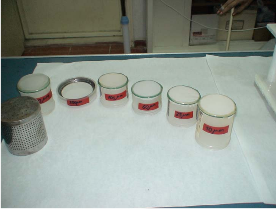
Şekil 6. Islak elek analizinde kullanılan elek sistemi.
