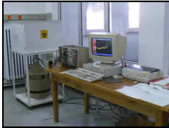
Şekil 3.15. Kimyasal verim tayini için kullanılan EDXRF sistemi
