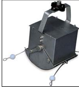
Şekil 3.3. Sediment örneklemesinde kullanılan “Ekman Grab”
