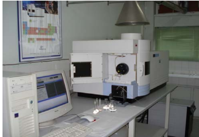
Şekil 3.17. Ağır Metal analizlerinin yapıldığı ICP-OES
