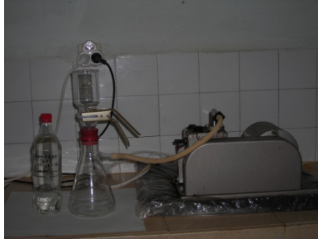
Şekil 3.5. Deniz Suyunda 210 Po Çöktürme işlemi
