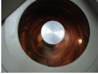
Şekil 3.14. Ortec GEM 150P4 HpGe Dedektörün iç ve dış görüntüsü
