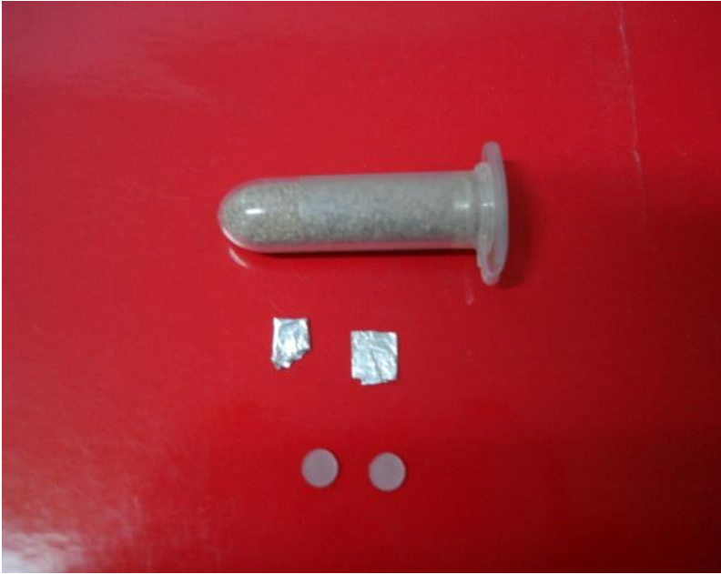
Şekil 3.10 Doğrudan metot ile yıllık doza gama kozmik radyasyon katkısının belirlenebilmesi için hazırlanan kalın \alpha\text{-Al}_2\text{O}_3\text{:C} dozimetreler.
