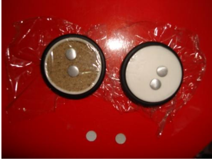
Şekil 3.13 Doğrudan metot ile yıllık doza beta radyasyonu katkısının hesaplanması için hazırlanan ince \alpha\text{-Al}_2\text{O}_3:\text{C} dozimetreler
