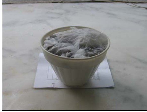
Şekil 3.1. Toprak örneklerinden nematod elde etmede kullanılan plastik saksı ve çelik kafes teli düzeneği.
