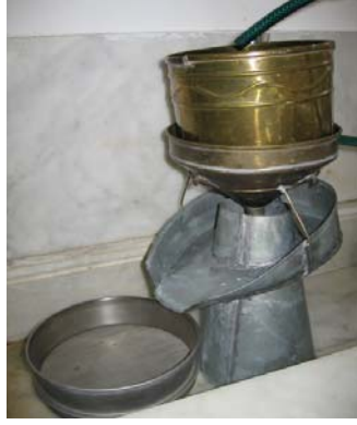
Şekil 3.2. Topraktan Heterodera avenae Wollenweber kistlerinin elde edilmesinde kullanılan Fenwick cihazı.
