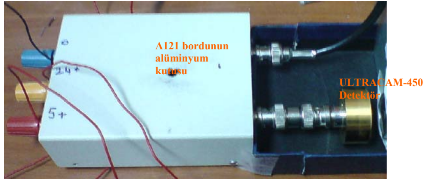
Şekil 3.7. A121 bordunun alüminyum kutusu ve ULTRACAM–450 detektör
