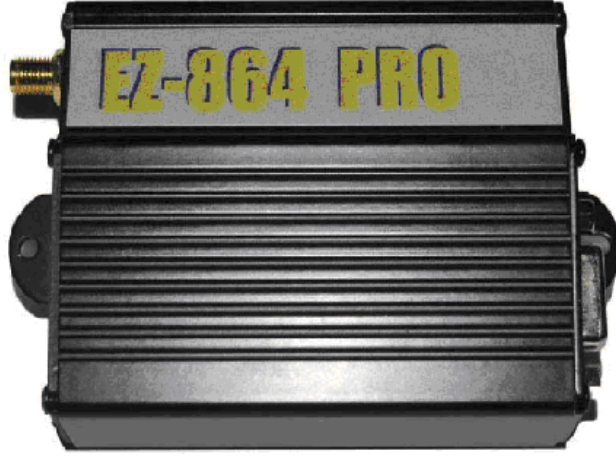
Şekil 3.11. EZ-864 model 900 MHz alıcı- verici modülü
