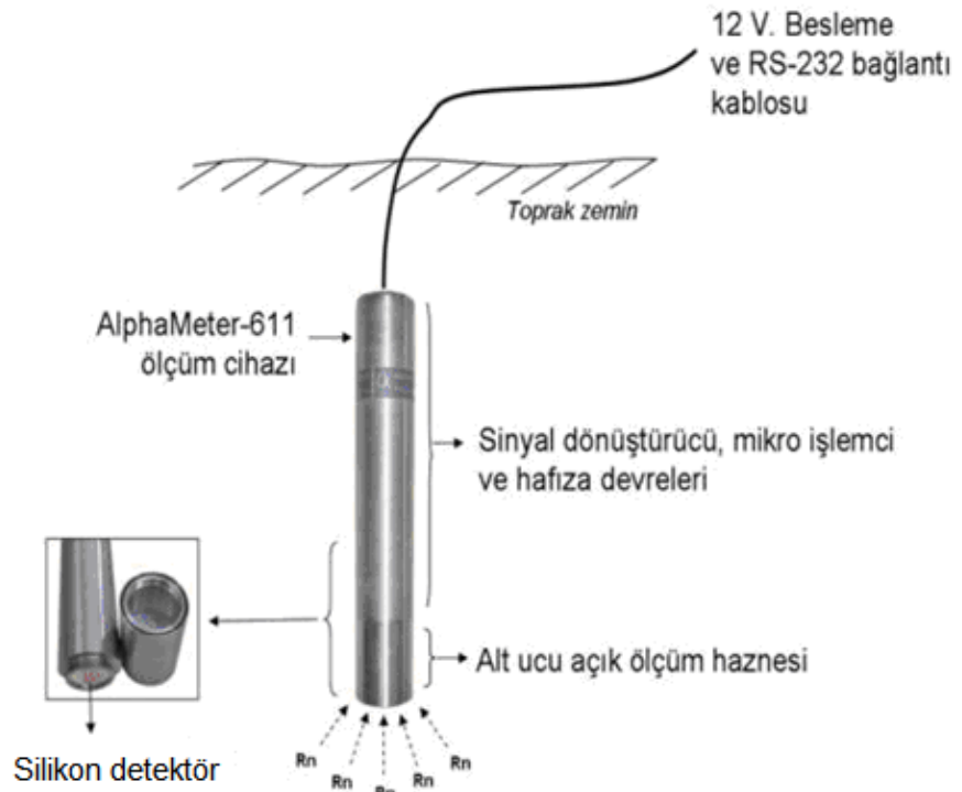
Şekil 2.14. Alphameter 611 radon ölçüm sisteminin çalışma işleyişi (İçhedef, 2011)
