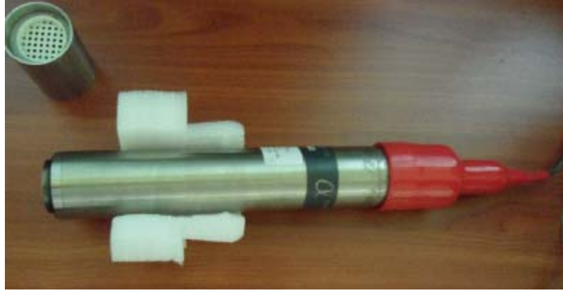
Şekil 2.13. Alphameter 611 radon ölçüm sisteminin görüntüsü
