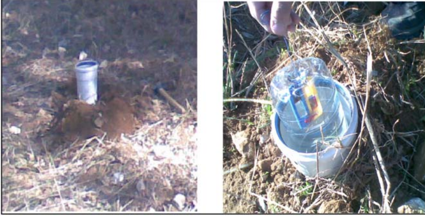
Şekil 3.27. LR-115 film detektörlerle toprak gazı radon ölçümlerinde ölçüm düzeneklerinin oluşturulması
