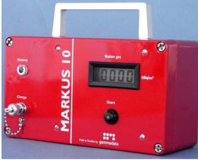
Şekil 2.6. Toprak gazı radon konsantrasyonlarının anlık olarak belirlenmesinde kullanılan Markus 10 sisteminin görüntüsü (Gammadata, 2012)
