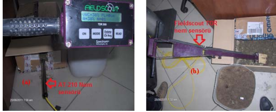
Şekil 3.14. (a) AT-210 nem sensörü (b) Fieldscout TDR nem sensörü
