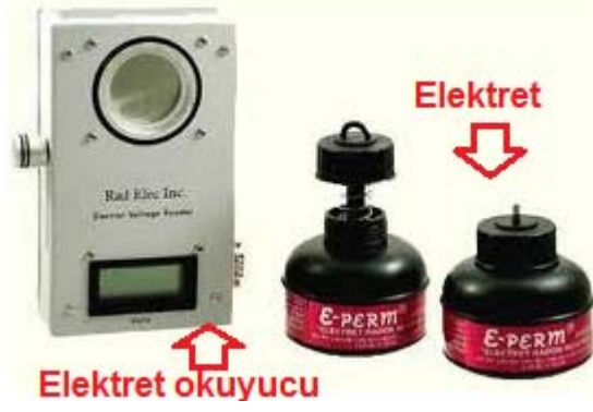
Şekil 2.8. Elektret okuyucu ve elektret (Rad Elec, 2012)
